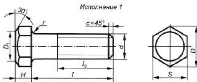
Рис. 2.30. Болт с шестигранной головкой нормальной точности исполнения 1
